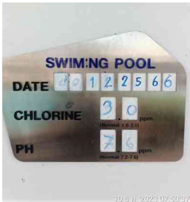
ภาพที่ 3-7(7.2) ช่างอาคารตรวจสอบคุณภาพน้ำสระว่ายน้ำน้ำ เข้า-เย็น ทุกวัน
